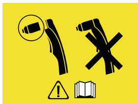
Figura 5.17 - Pantalla de error de instalación de la antorcha o ítems de consumo
